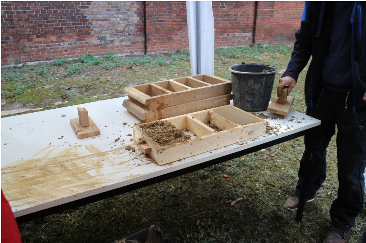
Herstellung von Lehmziegeln
