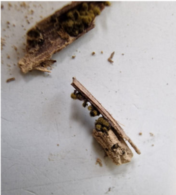
Organische Fasern; Innenseite bedeckt mit Schimmel
