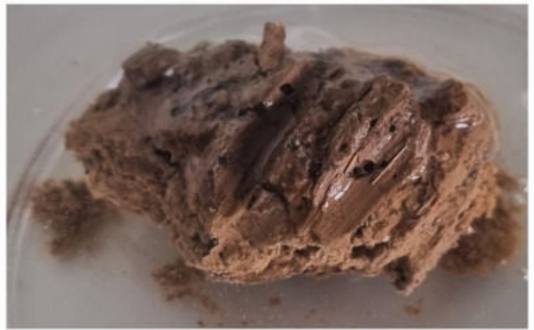
Lehmbewurf nach 5 min; Wasser hochgezogen
