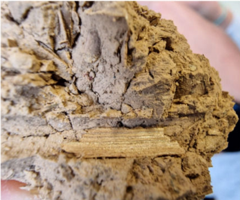
Lehmwurf (Ahrweiler) eingearbeitetes Stroh
