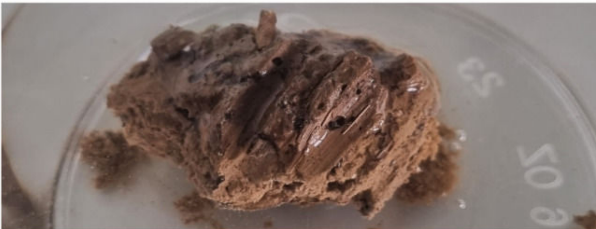
Lehmewurf in Wasser; erkennbares Zerfallen an den Seiten
