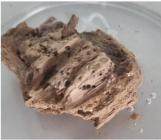
Lehmbewurf in Wasser; oberer Bereich trocken
