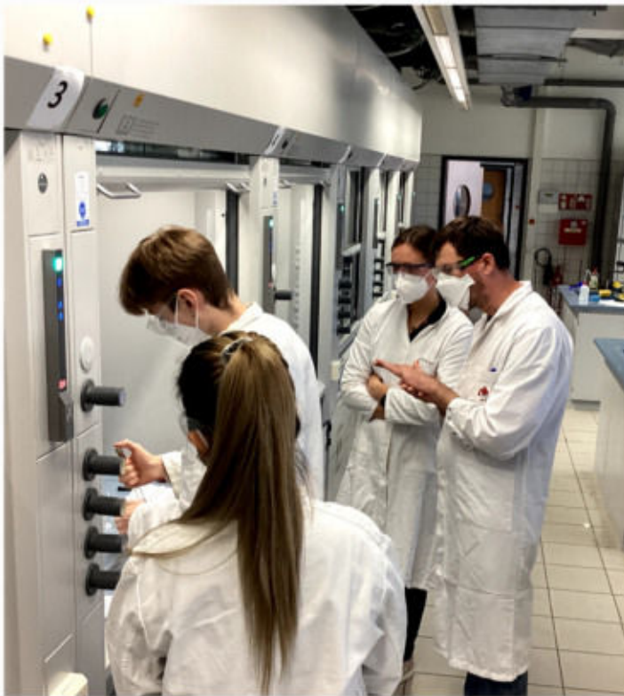
Untersuchung der Beständigkeit einzelner Baumaterialien in Umgebungen mit verändertem pH-Wert
