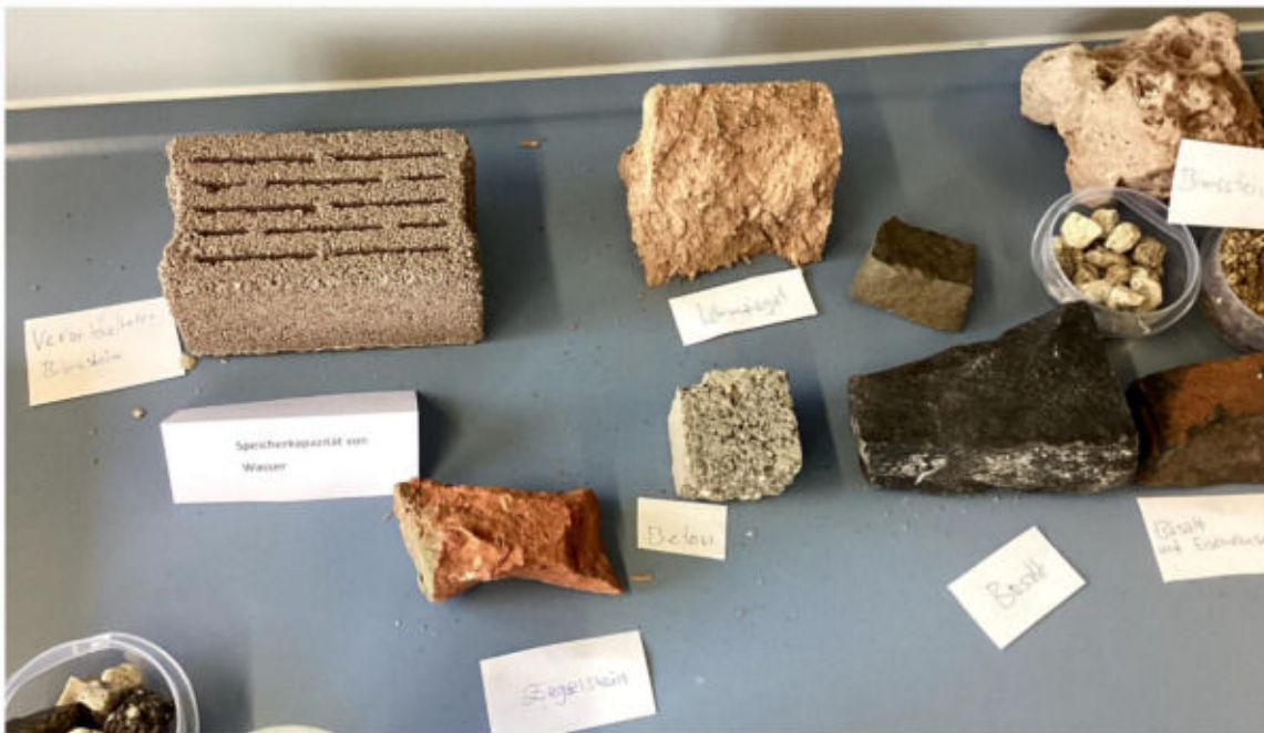
Verschiedenste Baumaterialien ( hier zur Speicherkapazität von Wasser)
